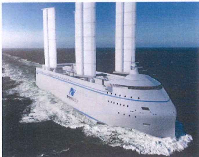
Esquisse du futur « Canopée » doté de quatre ailes rigides orientables développées par VPLP Design.
